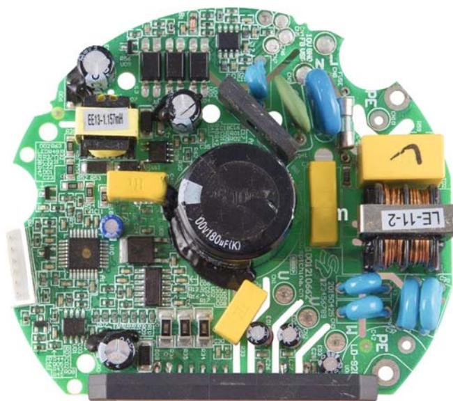
Teil der Leistungselektronik eines Inverters
