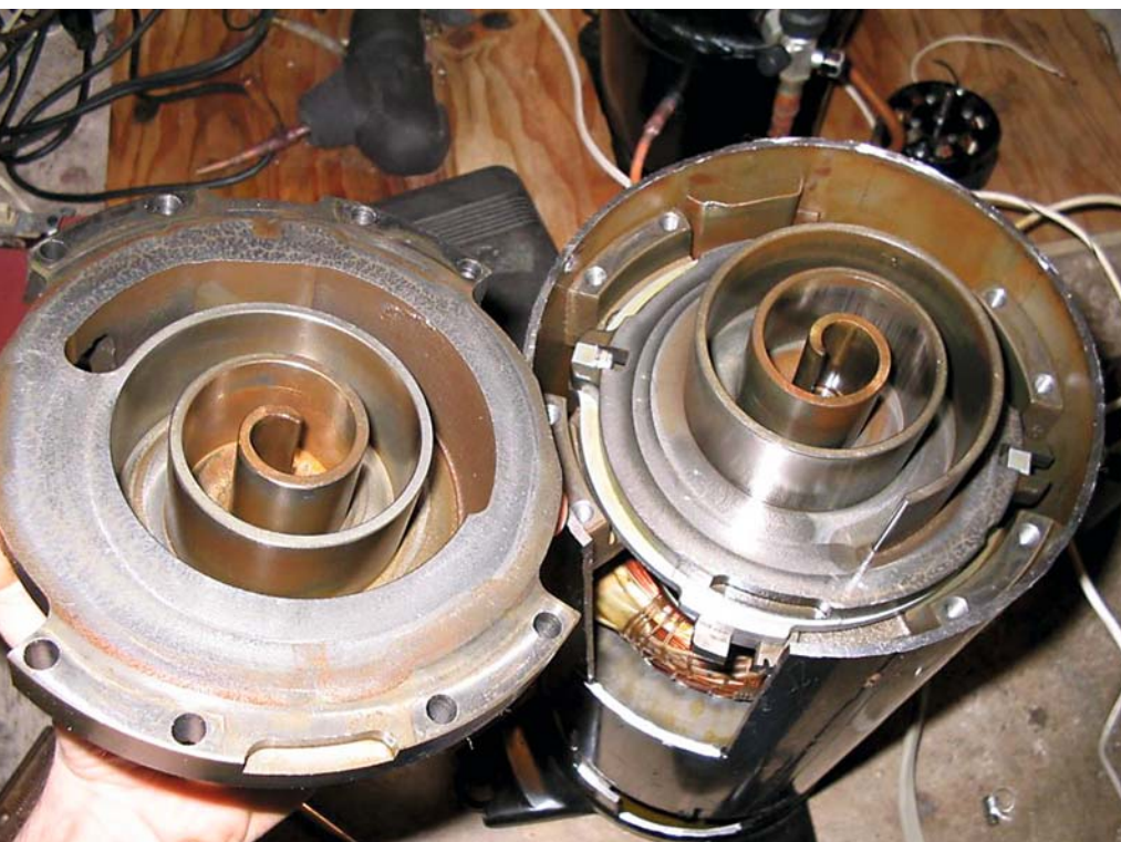
Der Scrollverdichter mit der sich drehenden Spirale auf der Motorwelle (rechts) und der festmontierten Spirale (links)
